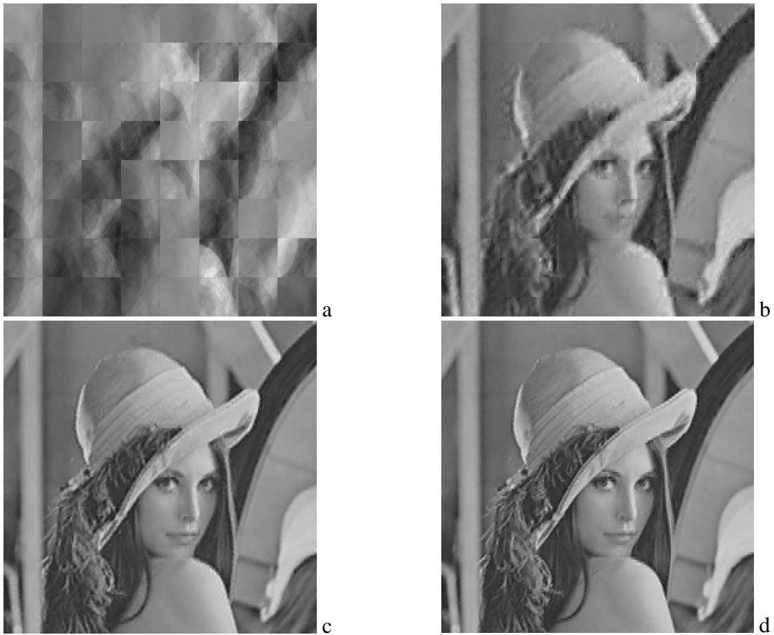
Figura 1.13: Imagen descomprimida para mosaicos de: a) 64x64, b) 32x32, c) 16x16, y d) 8x8
